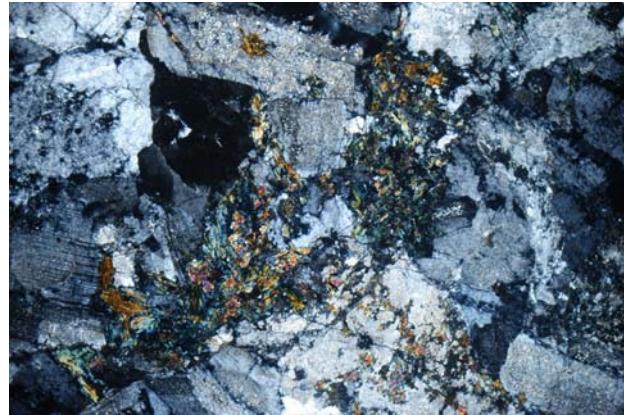
調査依頼を受けた「麦飯石」から、学芸員が作成した岩石薄片の写真です。上下の写真は、別々の「麦飯石」です。薄片写真から、これら両方とも、花崗岩質深成岩（カリ長石が比較的多い）花崗岩だと思います。上の岩石は、風化や変質もないですが、下の岩石は、変質が進んでいて、色鮮やかで細かい別の鉱物ができています。写真の横幅は両方とも約6cmです。
