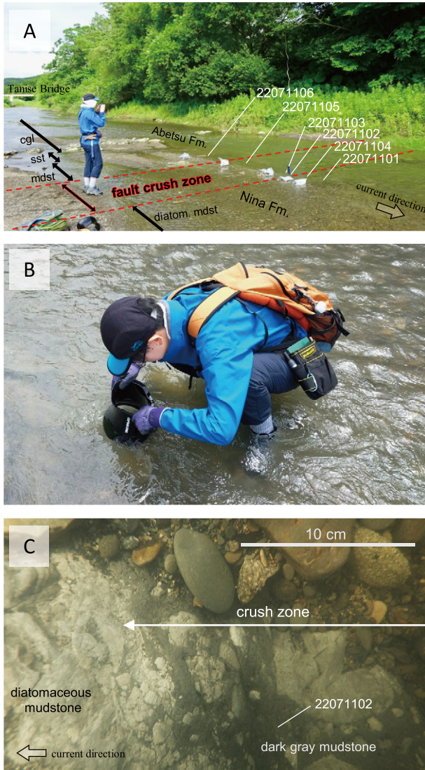
図 7. 波恵川における平取断層の断層露頭の写真。A. 平取断層付近の写真。B. 水中のぞきめがねを使った調査の様子。C. 断層破碎帯と荷葉層。2022年7月11日撮影。
